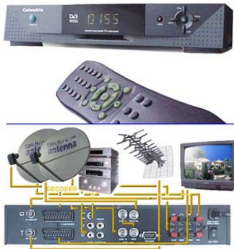
Obr. 2.24 Družicový prijímač s integrovaným dekodérom a pripojenie jednotlivých komponentov k zostave
