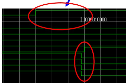
Obr.4 Výsledky časovej simulácie VHDL kódu čítača+1 v obvode EPF10K20RC240-4
