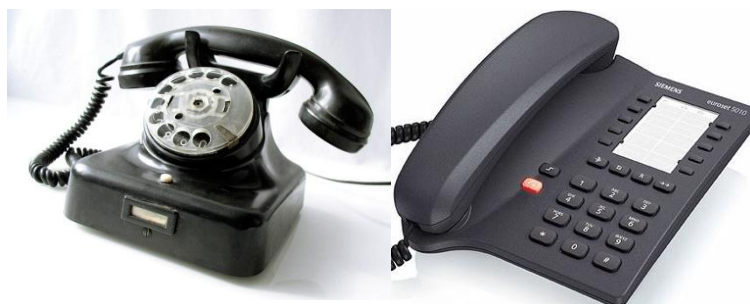
Obr. 1.3 Telefon s rotační číselnicí a tlačítkový s DTMF volbou
