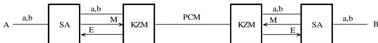
Obr. 3.18 Princip přeměny A/D s použitím EM
