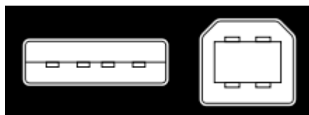
Obr. 3.18 USB konektory typ A a B
